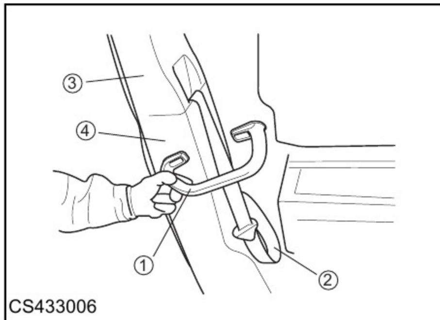
12 撬下 A 柱拉手总成堵盖, 拧下螺钉, 拆下 A 柱拉手本体。
